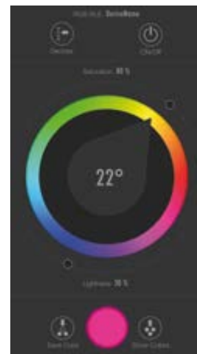
Regler für den Farblauf in %, Helligkeit und Dimmbarkeit von LED-Leisten RGB-ww (farbig & warmweiß)
